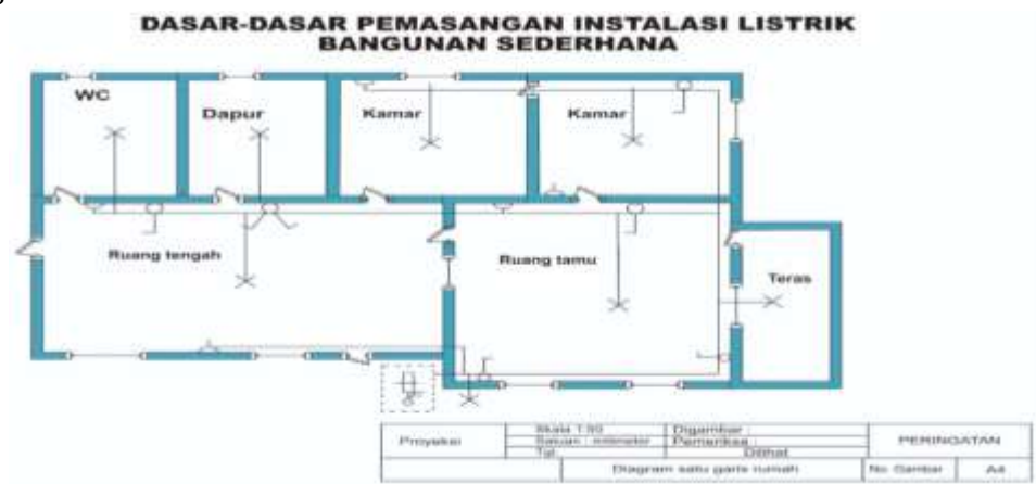
Gambar 2. Desain Denah rangkaian Instalasi Listrik Bangunan Sederhana
