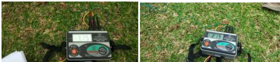
Gambar 4. Hasil Pengukuran Tahanan Pembumian
