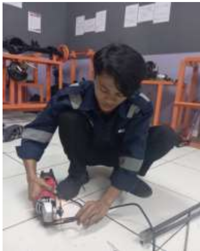
Gambar 4. Proses pemotongan material tracker shockbreaker
